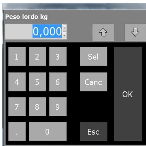
In questa finestra è possibile inserire un peso manualmente semplicemente utilizzando la tastiera del PC oppure se il software è installato su un PC touchscreen premendo direttamente sui tasti numerici della finestra e confermando con OK.
